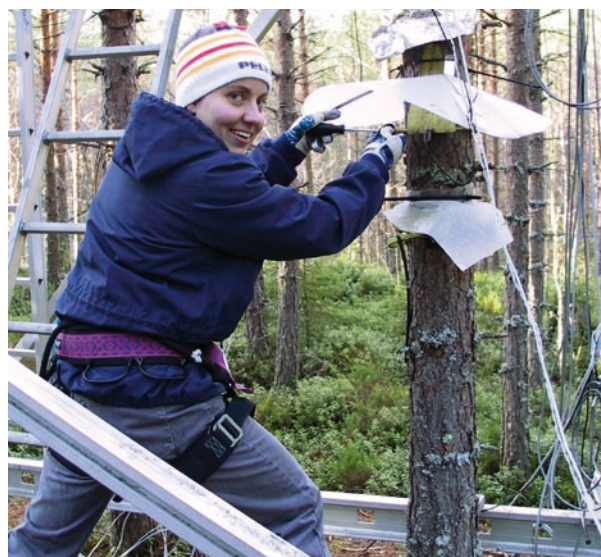
Sanna Sevanto mittaa männyn rungon läpimitan muutoksia SMEAR II -asemalla.
